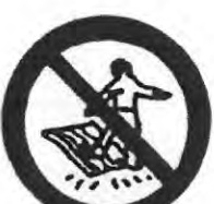
PROHIBIDO PISAR SUELO NO SEGURO
